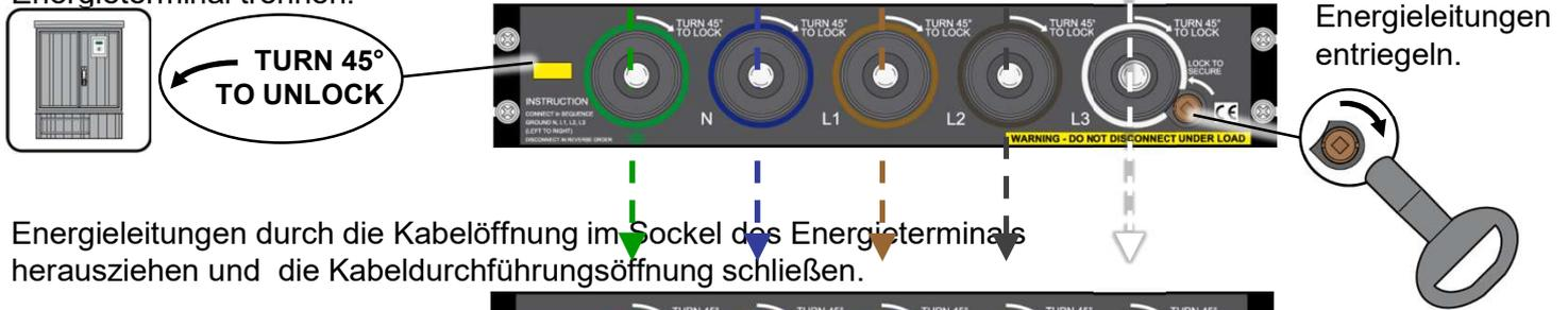
II. Energieleitungen durch die Kabelöffnung im Sockel des Energieterminals herausziehen und die Kabeldurchführungsöffnung schließen.
